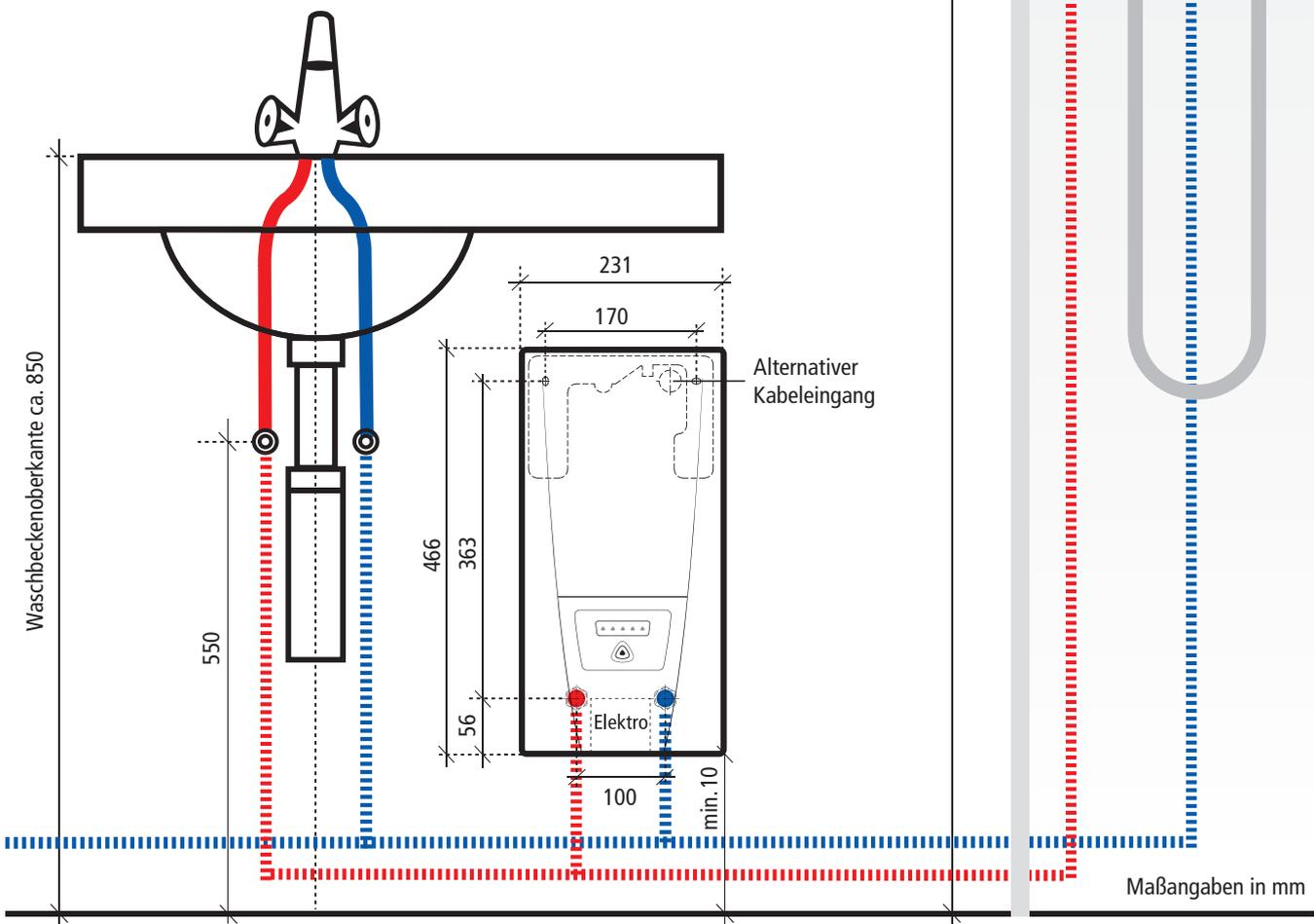
Universal-Montagerahmen mit Montagezubehör sind verfügbar für besondere Installationen, z.B. bei Elektroanschluss an beliebiger Stelle hinter dem Gerät, Untertisch-Installation oder Versatzmontage.
