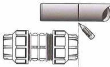
5. Drücken Sie das Rohr in die Rohrverschraubung, bis es hinter dem Gummidichtring auf den inneren Stopper stößt. Die Markierung auf dem Rohr soll die Mutter erreichen.
